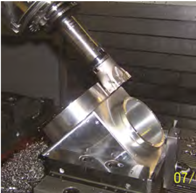
Problemlose Fertigung dank vorangegangener NC-Code-Simulation
