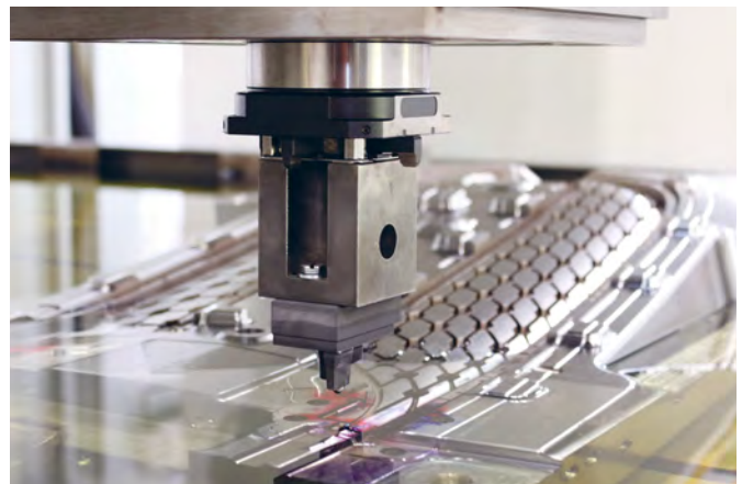
Elektrode im Einsatz beim Senkerodieren
