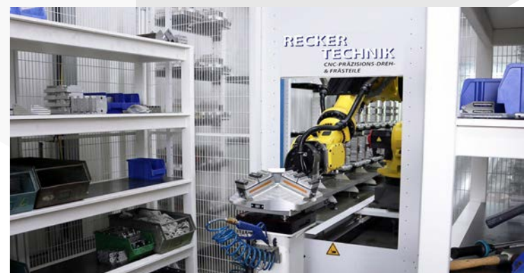
Roboter übergibt Spannpyramide mit 3 Schraubstöcken in die Bestückungsschleuse
