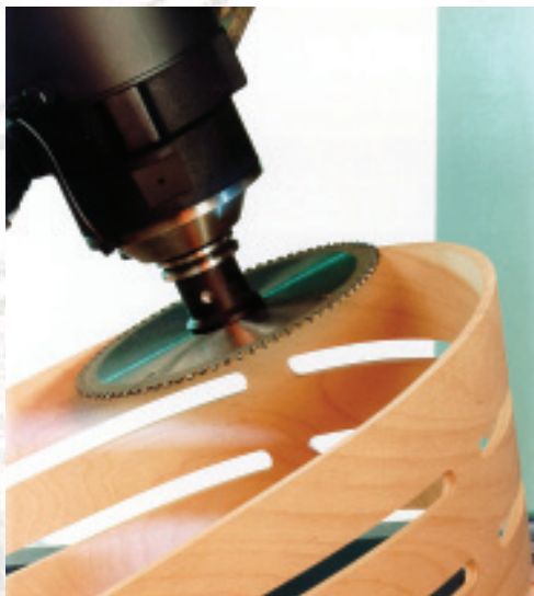
Schwenkbare Bohr- und Fräsaggregate mit Sägeblatt
